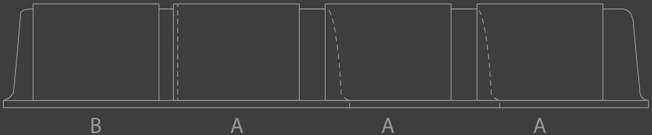
Cada molde cuenta con una pestana de 10 cms la cual se ensambla con el siguiente molde, esto te permite cubrir la distancia necesaria. Cuenta con un espesor de 25 cms en la ceja la cual te permite no tener que colocar triplay
